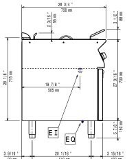
Electrical inlet (power) Equipotential screw
